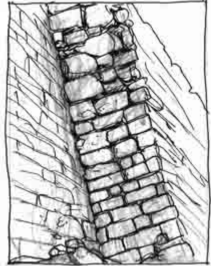
Akresyondaki tabakalar, kurnetli değişimlerle. Djozer Piramidi
