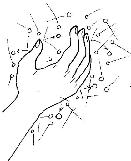
Um objecto colocado num fluido é submetido a uma infinidade de pequenos choques moleculares. Dessa maneira, as moléculas podem transmitir e trocar energia, CALOR. A capacidade de transmitir calor cresce com a densidade do fluido. Por essa razão, a água conduz melhor o calor do que o ar.
