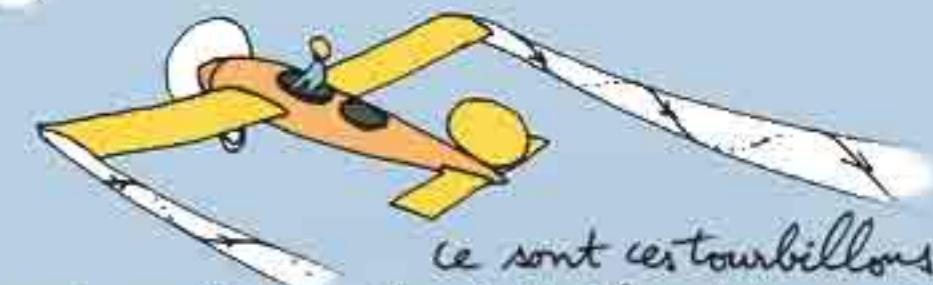
ce sont ces tourbillons qui se créent en bout d'aile qui provoquent en haute altitude des condensations de vapeur d'eau (traînées de condensation)
