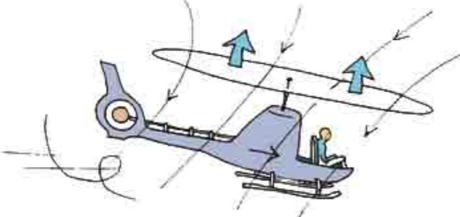
Si je pouvais accroître la portance des pales de mon rotor quand celles-ci sont vers l'arrière et la diminuer quand elles sont vers l'avant, à l'aide d'une **VARIATION CYCLIQUE DU PAS** je pourrais provoquer le basculement de ma machine et l'engager dans un mouvement de **TRANSLATION**
