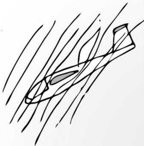
après une ABATTEE le planeur reprend naturellement de la vitesse. L'écoulement se RECOLLE sur le profil. La portance réapparaît brutalement, du fait du gain de vitesse  $V$ . Quand le pilote sent que son planeur décroche, s'enfoncé il peut accélérer ce retour à une configuration normale en piquant légèrement, en poussant sur le manche, en RENDANT LA MAIN.
