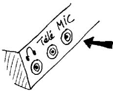
le transfert va s'effectuer à l'aide du fil habituellement relié à un microphone. Il sera, bien sûr, nécessaire d'enfoncer préalablement la, ou les touches d'ENREGISTREMENT du magnétophone. La broche centrale permet de déclencher le mouvement de la bande directement à partir du clavier de l'ordinateur, et celui-ci démarrera dès que la touche [Fin de message], suivant l'ordre `CSAVE "PRO-1"` aura été pressée. Il s'arrêtera automatiquement.
