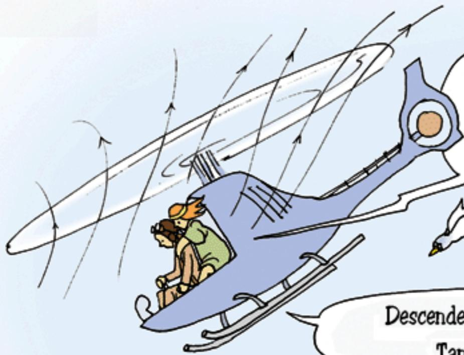
Muy bien, ahora el aire está en flujo inverso, pasando de abajo hacia arriba. Hemos cambiado a un régimen de **AUTORROTACIÓN**. Mi helicóptero se ha transformado en autogiro. La parte motriz y autogiratoria del rotor arrastra al resto
