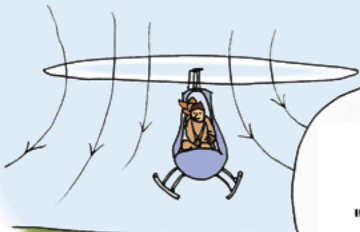
Ahora tira de la palanca de paso colectivo. El flujo de aire se invierte. El rotor pasa entonces del régimen de "autogiro" al régimen de "helicóptero". Aprovechando el efecto suelo utiliza la energía cinética almacenada por el rotor (\*\*)
