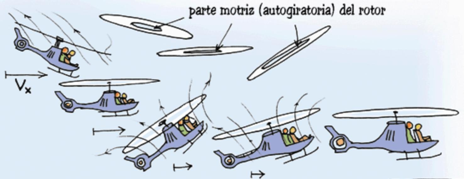
A diez metros de altura, Cándido tira decididamente de su mando manteniendo el paso colectivo al mínimo. La máquina se encabrita y las palas son enfrentadas por una incidencia de viento relativo mayor que aumenta la parte del rotor que es "motriz" y autogiratoria. De esta forma convierte la energía cinética de translación  $\frac{1}{2} M V_x^2$  en  $\frac{1}{2} M V_x^2$  energía de rotación. Después empuja nuevamente el mando.
