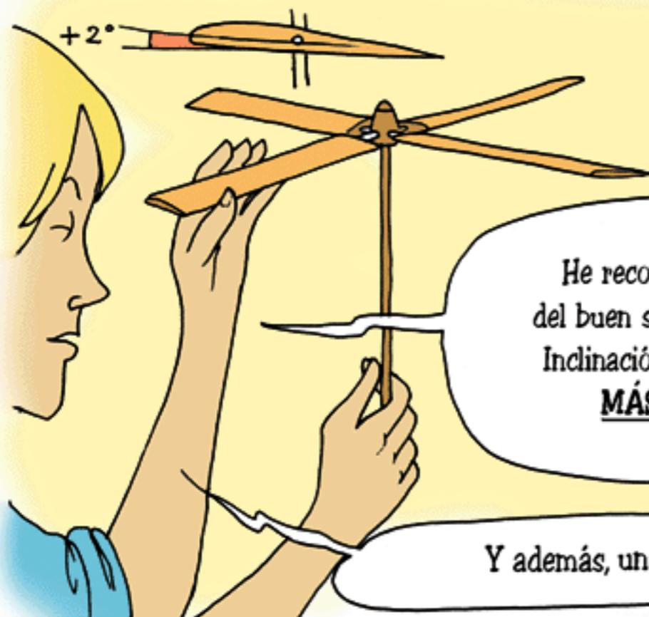
He reconstruido el rotor del buen señor de la Cierva. Inclinación de las palas = **MÁS** dos grados
