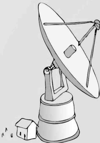
Obtenemos imágenes de esta radiación de radio usando los grandes espejos de los radiotelescopios en los que la superficie reflectora es una simple retícula cuyas mallas se adaptan a la longitud de onda de la señal (como en los hornos micro-ondas).
