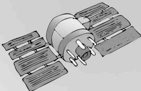
El sistema **GPS** utiliza una treintena de satélites ubicados a 20.000 km de altura, dotados de relojes atómicos de gran precisión.
