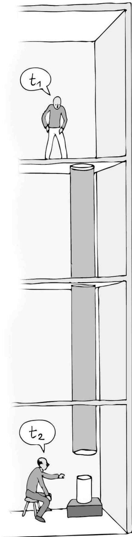
El diseño experimental de 1960 de los norteamericanos Pound y Rebka preveía un montaje sencillo pero ingenioso que permitía comparar las frecuencias de emisión de rayos gamma de dos fuentes constituidas por isótopos de  $^{57}\text{Fe}$  de hierro, dotados de un neutrón adicional. La diferencia de altura era de 22 metros. Usaron para ello la fórmula establecida en 1916 por el alemán Karl Schwarzschild (\*):
