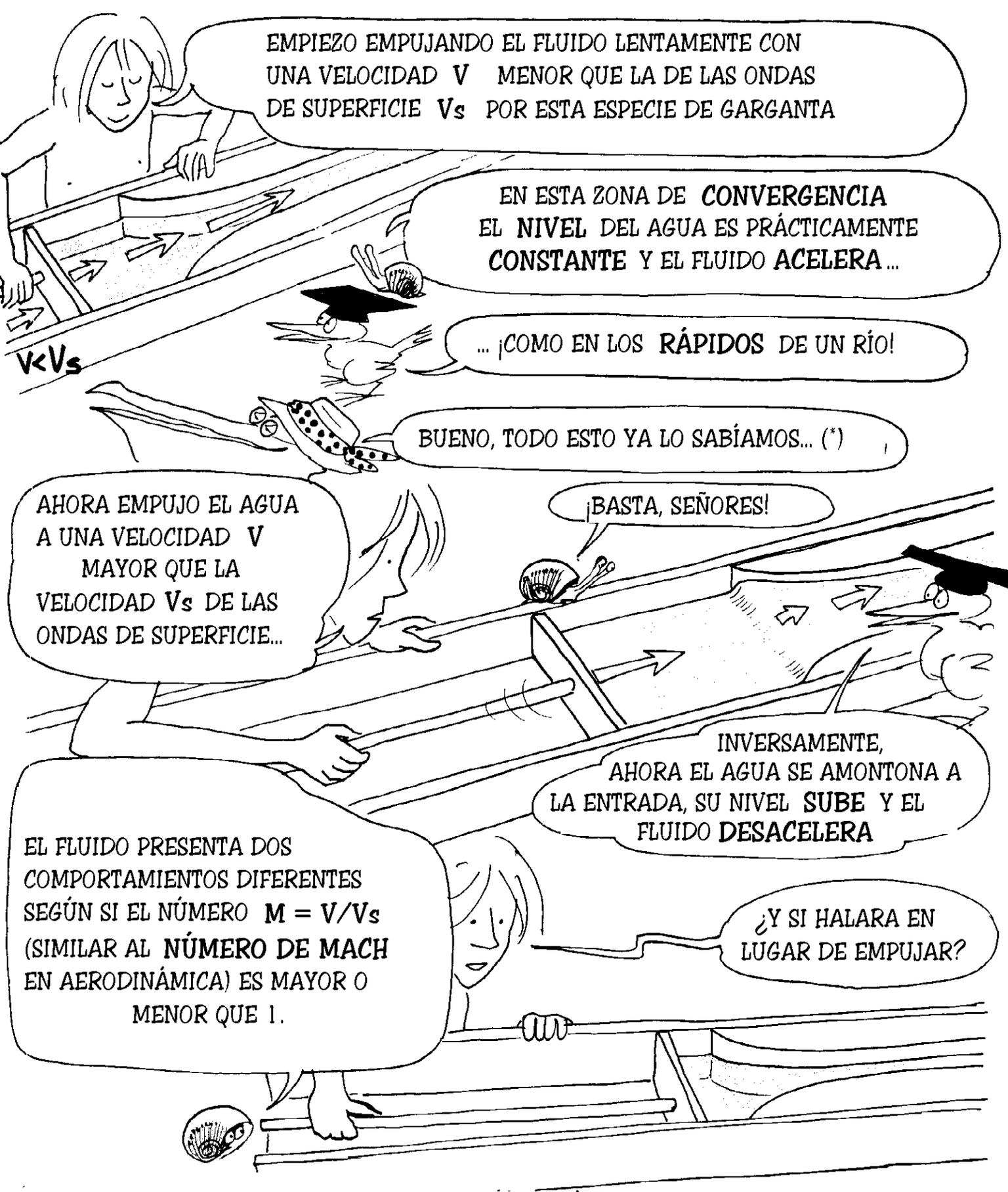
EMPIEZO EMPUJANDO EL FLUIDO LENTAMENTE CON UNA VELOCIDAD  $V$  MENOR QUE LA DE LAS ONDAS DE SUPERFICIE  $V_s$  POR ESTA ESPECIE DE GARGANTA
