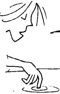
CUANDO COLOCO SÚBITAMENTE EL DEDO EN LA SUPERFICIE FORMA UN PLIEGUE QUE TIENDE A SER ELIMINADO POR UN MECANISMO OSCILATORIO, POR ONDAS DE SUPERFICIE QUE SE VAN ATENUANDO Y QUE SE PROPAGAN CON UNA VELOCIDAD QUE LLAMARÉ  $V_s$
