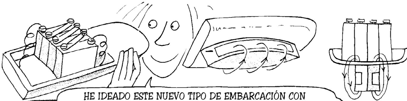
HE IDEADO ESTE NUEVO TIPO DE EMBARCACIÓN CON UN IMÁN PERMANENTE BAJO EL CASCO Y LOS ELECTRODOS UNIDOS A UNA BATERÍA
