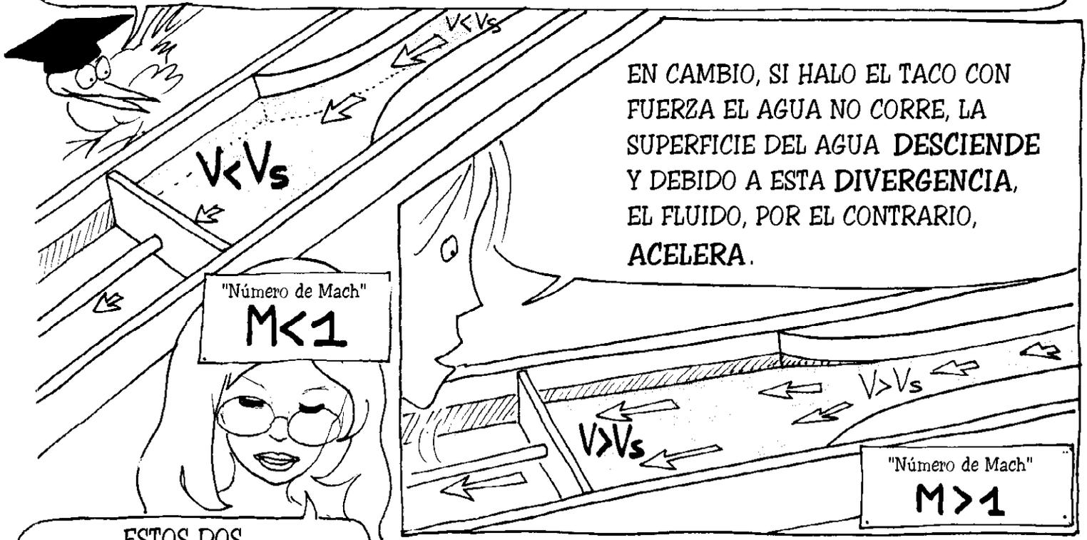
EN CAMBIO, SI HALO EL TACO CON FUERZA EL AGUA NO CORRE, LA SUPERFICIE DEL AGUA DESCENDE Y DEBIDO A ESTA DIVERGENCIA, EL FLUIDO, POR EL CONTRARIO, ACELERA.
