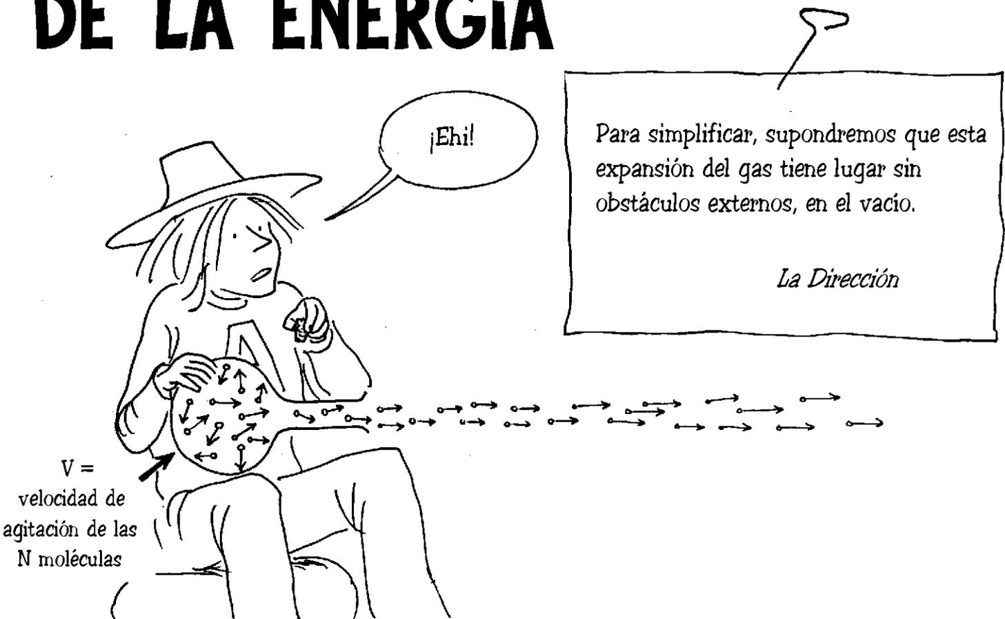
Si esta transformación CALOR → MOVIMIENTO es total, las moléculas tendrán todas la misma velocidad  $v$  (de ensamble) y la energía del sistema será la energía
