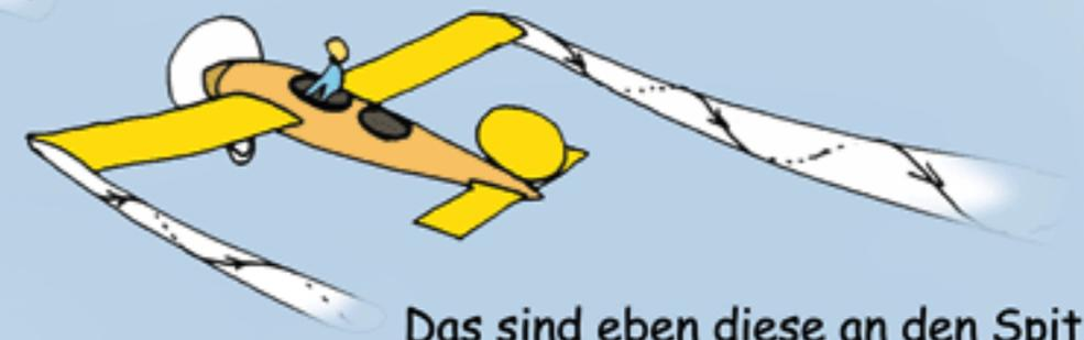
Das sind eben diese an den Spitzen der Tragflächen erscheinenden Wirbel, die in großen Höhen den Wasserdampf zum Kondensieren bringen und sog. Kondensstreifen verursachen.
