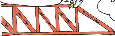
Diese Verstreben stehen unter **ZUGSPANNUNG**.
