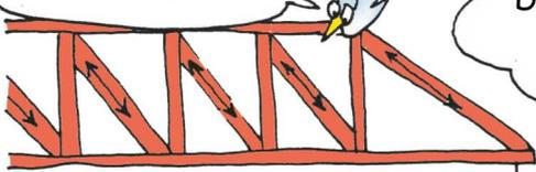
Diese Verstreben stehen unter **ZUGSPANNUNG**.
