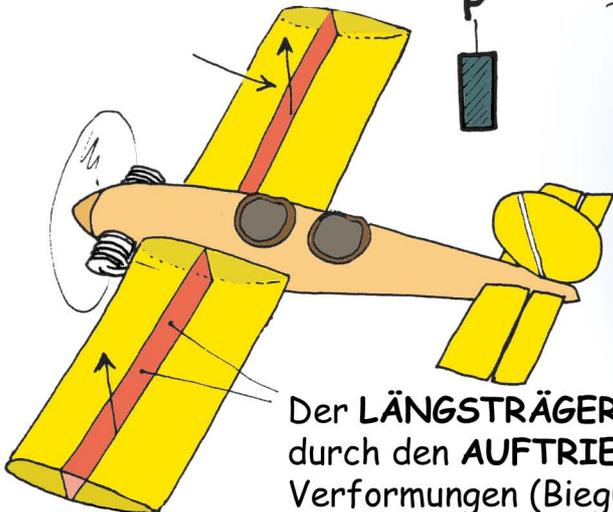
Der **LÄNGSTRÄGER** hält den durch den **AUFTRIEB** verursachten Verformungen (Biegungen) stand.
