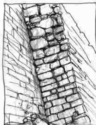
Lage in Abstützung mit grobem Gestein, Pyramide von Djozer.
