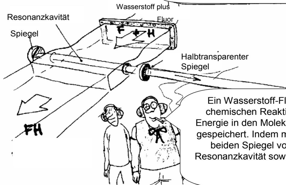
Ein Wasserstoff-Fluor-Laser. Während der chemischen Reaktion wird ein Überfluss an Energie in den Molekülen des Fluorwasserstoffs gespeichert. Indem man das Gas zwischen den beiden Spiegel vorbeileitet, lässt man die Resonanzkavität sowie das Lasergas entstehen.
