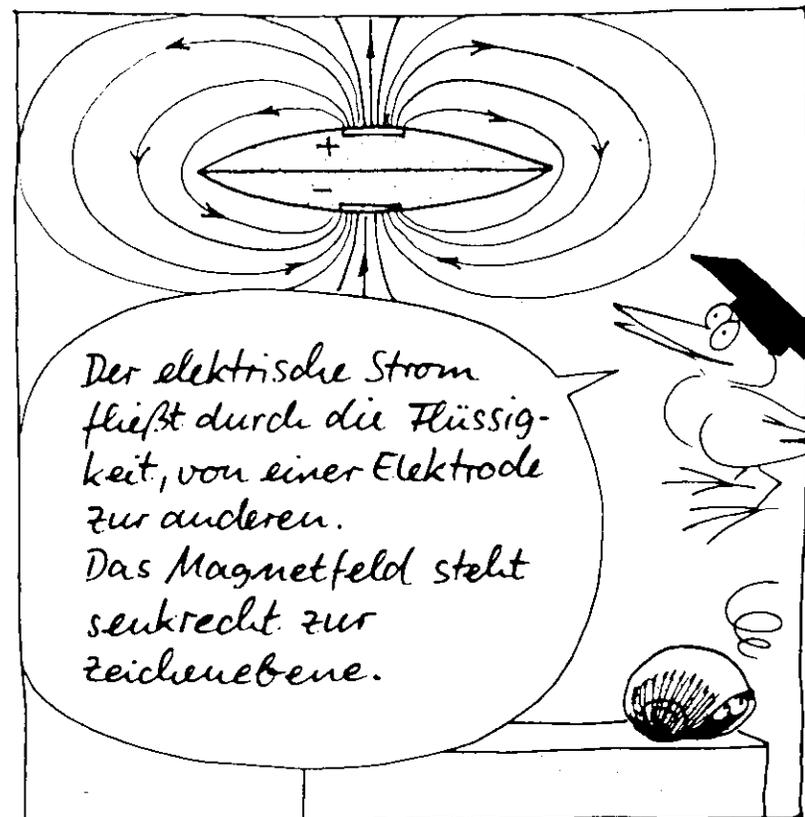
Die Dreifingerregel liefert mir das Kraftfeld, dem die Flüssigkeit ausgesetzt ist.
