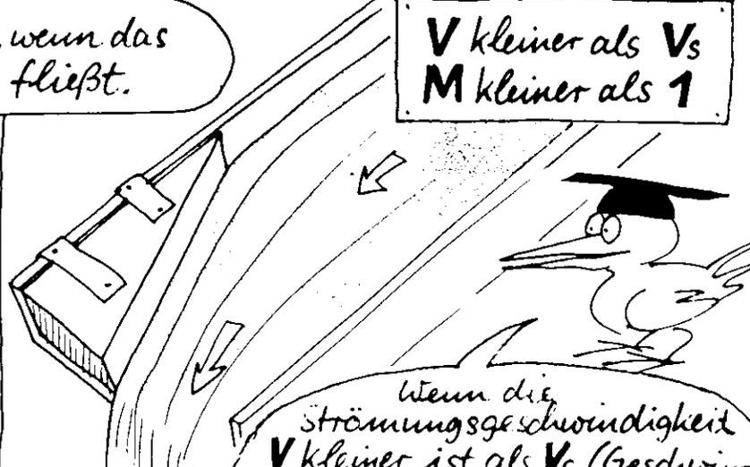
Wenn die Strömungsgeschwindigkeit  $V$  kleiner ist als  $V_s$  (Geschwindigkeit der Oberflächenwellen), nimmt  $V$  in der Verengung zu und die Wasserhöhe bleibt konstant.
