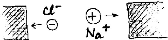
Ovaj klorid ion  $\text{Cl}^-$  se giba ka anodi dok  $\text{Na}^+$  ion ide ka katodi.
